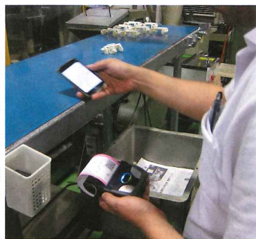
▲スマホに取り込んだデータをハンディプリンターで印刷して伝票にする
